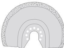
Lâmina de carboneto para remover argamassa. (Número de peça - STA26125-XJ)
